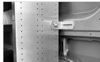
L-úhelník nastavený mezi regálem a nosníkem karoserie
